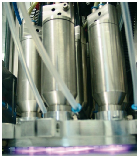
Plasmadüsen-Kombination zur Beschichtung großflächiger Substrate.
